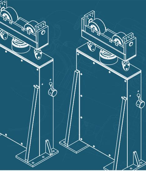
El balance debe realizarse a un número de revoluciones superior a la frecuencia de resonancia de las suspensiones.
