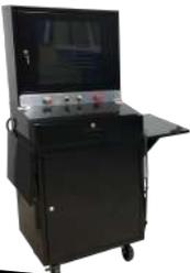
Gabinete con panel de control con botones de arranque, paro, cambio de rotación y velocidad de giro. Cuenta con compartimientos para la PC y para almacenamiento de tus herramientas y dispositivos de balanceo.
