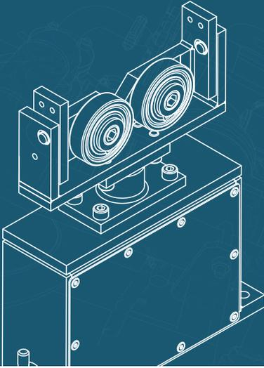
El balance debe realizarse a un número de revoluciones superior a la frecuencia de resonancia de las suspensiones.
