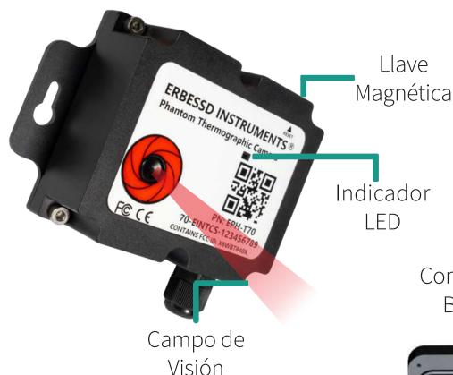
Nuestros módulos Phantom usan 2 baterías AA, esto hace que sean muy fáciles de cambiar y reemplazar.
