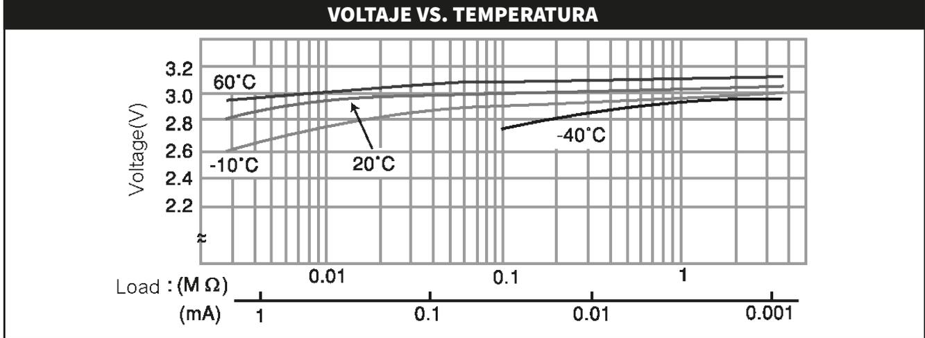
\*La duración de la batería se ve directamente afectada por la temperatura, la frecuencia de las alarmas y otros factores independientes de la configuración del usuario.
