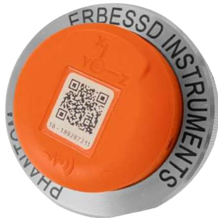
Una vez colocado el sensor en la máquina, configúralo en DigivibeMX y define cada eje dependiendo de su orientación: Horizontal, Vertical y Axial.
