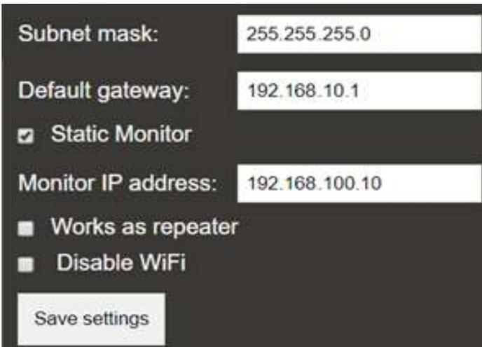
8- Inicie el servicio **El Monitoring Service** en su PC o conecte el **Cloud Connector** al router y espere a obtener Monitor IP en la pantalla del Gateway.
